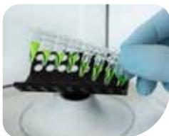
**ROTOR À BARRETTES PCR** contenant quatre barrettes de tubes 0,2 ml ou 32 tubes uniques 0,2 ml
