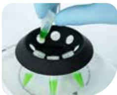
**ROTOR POUR TUBES** contenant jusqu'à huit microtubes ou huit tubes à vis coniques ou jupés
