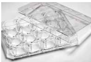
Couvercle avec détrompeur et anneaux de condensation afin d'éviter les contaminations croisées
