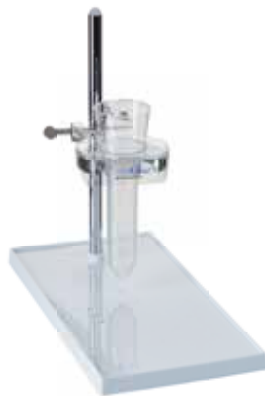
Anello di supporto con Sistema Filtrante per Tubi da Centrifuga 50 ml (Base non inclusa)
